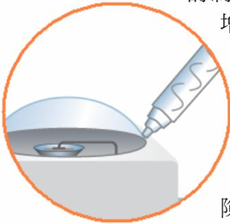
SmartGel 包含有低粘度的光學液體和兩液化學反應增硬型膠。可將尚未硬化的液體注入在發光二極體和鏡片之間的間隙中,待硬化後,就成為具穩定性,高透明度,長壽命的,兼具粘著性與伸縮性的光學膠。
